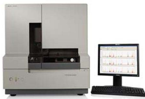
Рис. 80. Генетический анализатор АВ 3130 (Applied Biosystems). Прибор используют для секвенирования и генотипирования по молекулярным маркерам
